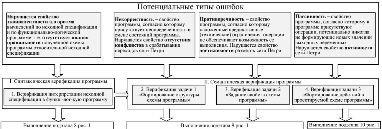
Рис. 9. Схема верификации функционально-логической программы вычислений
