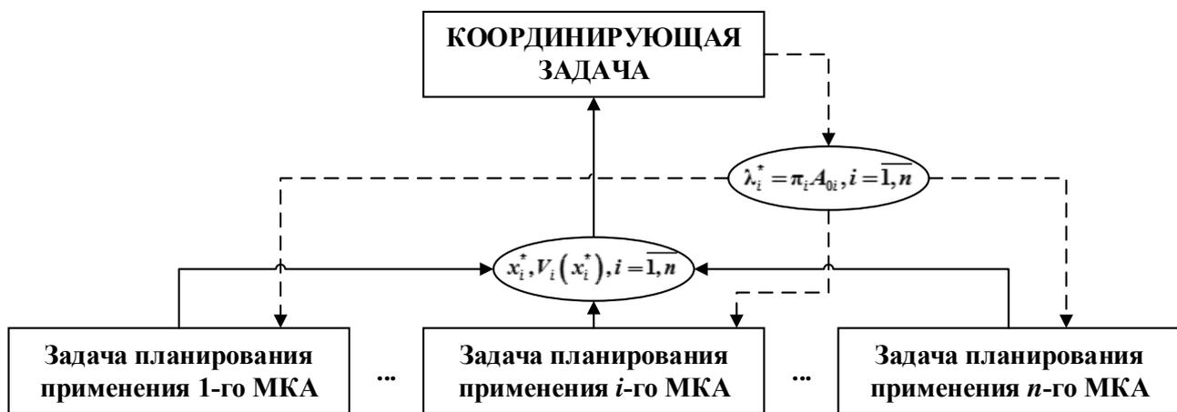
Рис. 2. Схема решения задачи планирования применения КМКА с использованием координационного подхода
